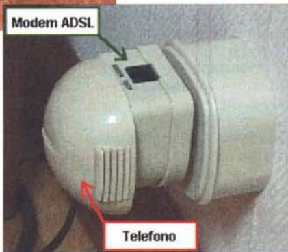
Vari tipi di adattatori tra spine Sip e spine RJ-11. Il discorso non cambia per i modem PSTN; mentre per l'ISDN la questione si complica.
